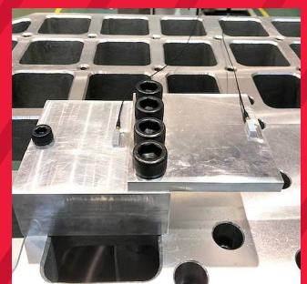
振動試験機を使用し、通常ボルトと抑制ボルトの比較テストから、充填剤の種類による違い、振幅や周波数を変えての試験等を重ねてきました。
